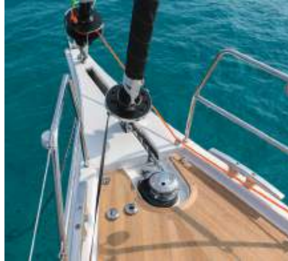
Fixed bowsprit for downwind sails mounting Delphinère fixe pour amurage des voiles de portant
